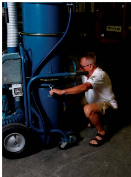
Behållaren sätts fast på maskinen med hjälp av de båda spämläsen.
